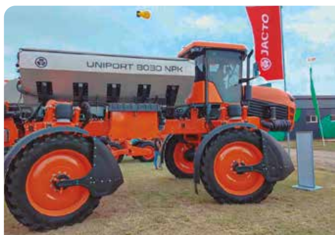
Nueva abonadora de Jacto con motor delantero, espaciosa cabina y tanque con capacidad para 8.000 kilos.
